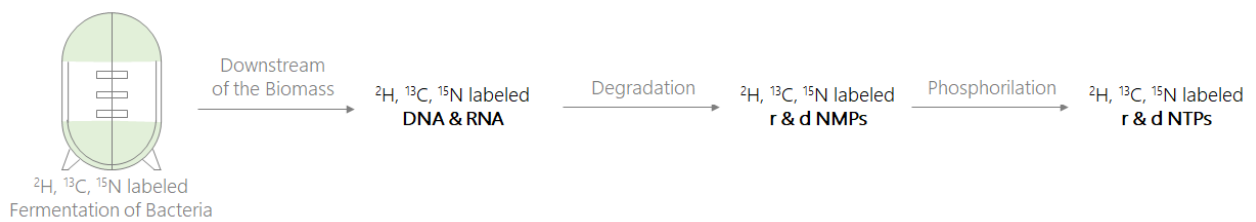
図1: シランテス社のバイオテクノロジーによるNTP製造プロセス
